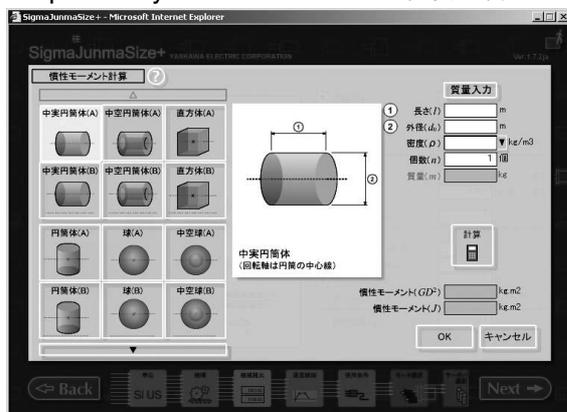
在超过容许负载转动惯量的情况下使用时, 减速时会发生过电压警报 (A.400)。此外, 伺服单元内置再生电阻器时, 会发生“再生过载警报 (A.320)”。发生此类警报时, 请采取以下任一措施。
