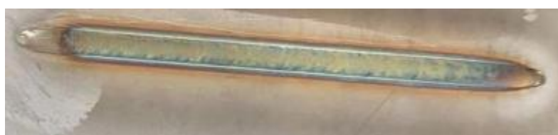
图 2 激光功率缓升缓降效果
