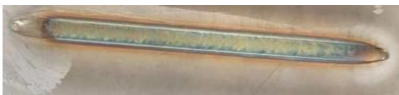
图 2 激光功率缓升缓降效果
